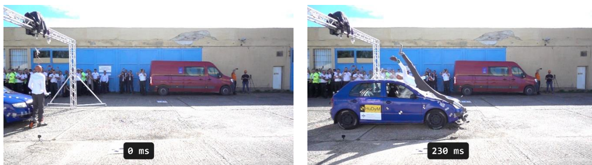
Obr. 5 Test 2: vľavo – okamih nárazu, vpravo – koniec hlavnej silovej interakcie
